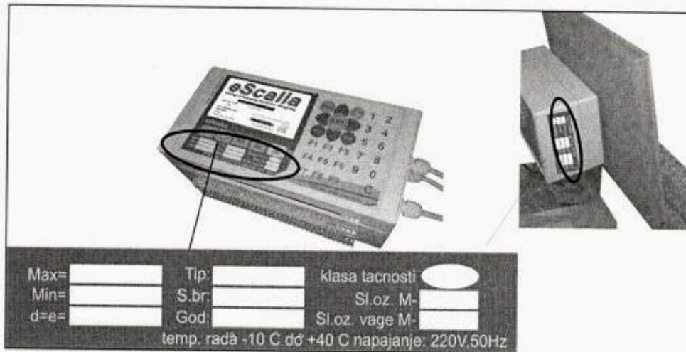
Слика 5. Изглед и позиција натписне плочице електронског мерног и показног уређаја
