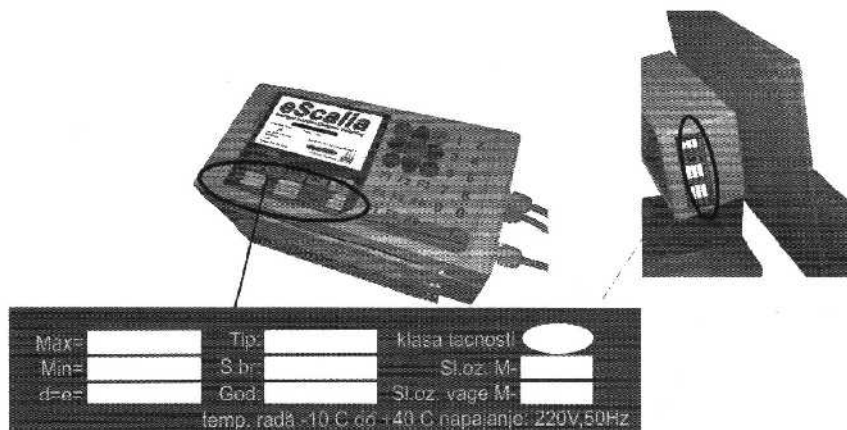
Слика 2. Изглед и позиција натписне плочице електронског мерног и показног уређаја
